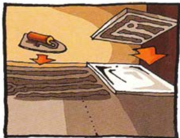
3：將濕潤狀的細砂與水泥漿攪拌後將之鋪於地坪上，在磁磚背面塗抹水泥漿，鋪貼於地坪上後，同時將敲實並效正其水平度。
