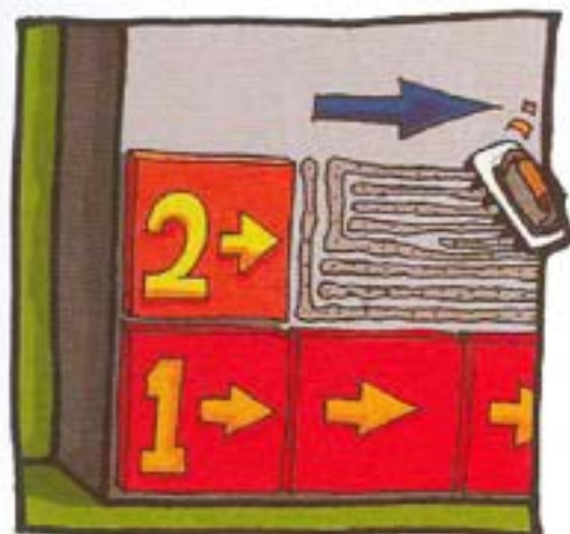
2：鋪貼時順手方向依放樣位置，橫向由下往上鋪貼。
