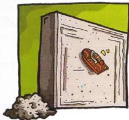
1：施以木鏝刀粉平之底以帶齒鏝刀將鋪貼用之4~6mm厚之水泥砂漿刮成凹凸狀。
