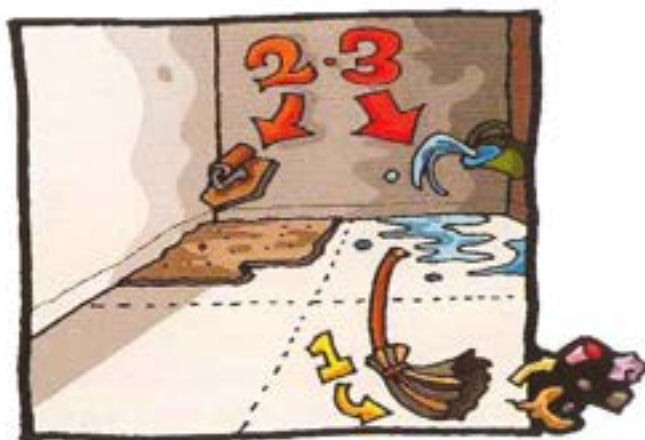
2：現場訂出水平線固定基準點，清除地上雜物，灑水並塗上水泥漿。
